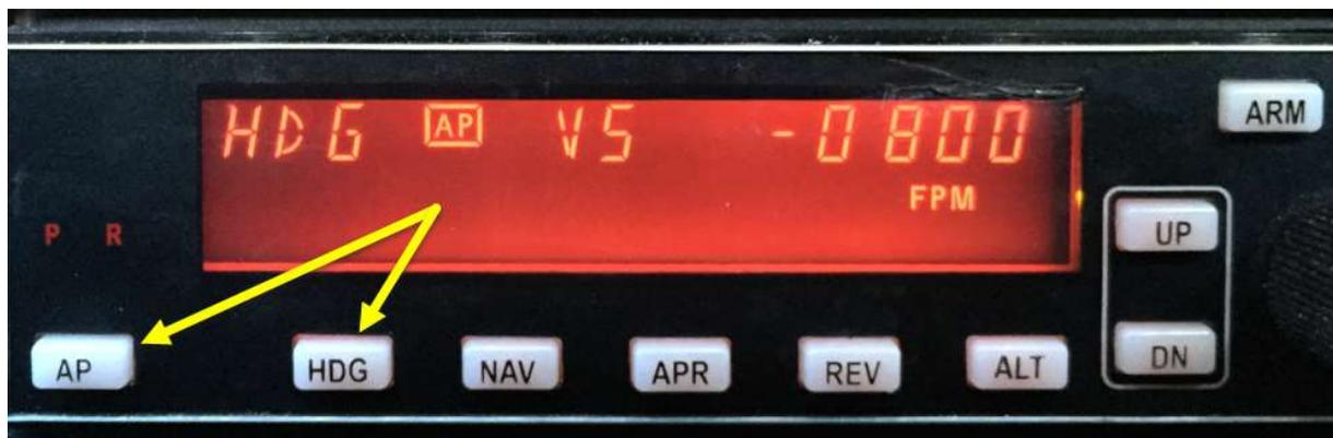
Nun schalten wir den Autopiloten ein, indem wir die Taste **AP** drücken. Anschliessend betätigen wir die Taste (HDG = Heading). Das Flugzeug beginnt sich abzdrehen und pendelt sich beim neu definierten Flugkurs 60° ein (sh. untere Abbildung). Da wir uns im Modus Autopilot befinden, können wir selbstverständlich die erforderliche Flughöhe resp. die Steig- oder Sinkrate einstellen, wie dies an anderer Stelle schon gezeigt wurde.
