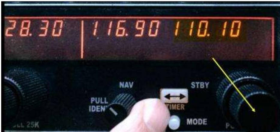
Mittels Drehknopf beim **COM/ NAV** 1 – Instrument stellen wir die Frequenz **110.10** ein.
