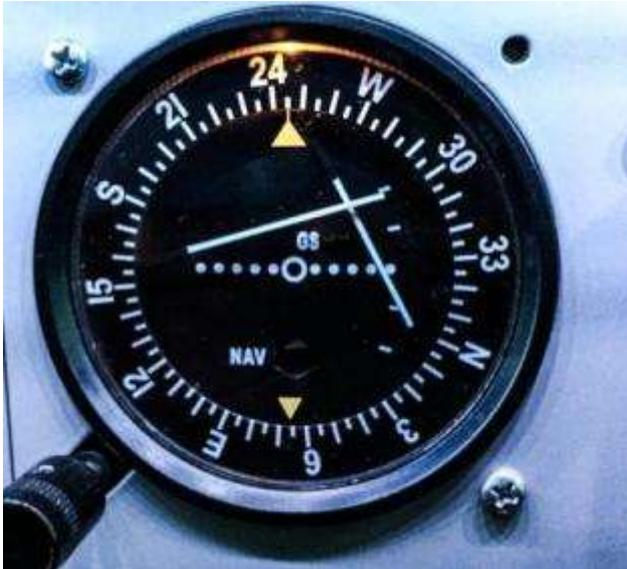
Bereits jetzt reagiert die VOR-Anzeige. Sie zeigt an, wo man sich gegenüber der Pistenachse 14 befindet. Die Funktion der beiden Nadeln wird später erklärt.
