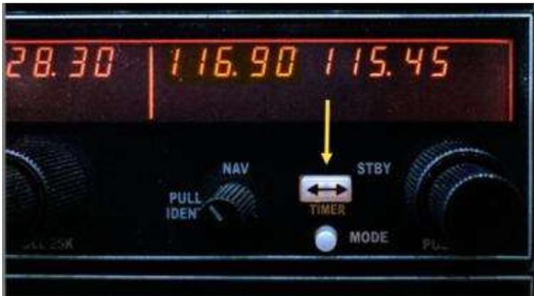
Die Frequenz wird mit der Taste ,TIMER' bestätigt.
