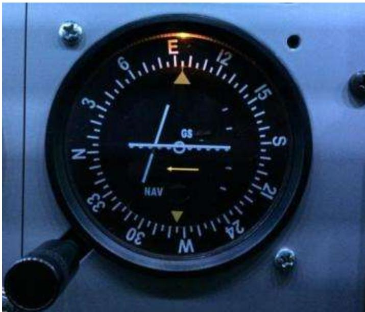
Das VOR-Instrument reagiert jetzt bereits schon, wenn es Kontakt mit dem VOR Willisau aufgenommen hat. Das kann man testen, indem man beim Kopf des VOR-Instrumentes dreht. Die definitive Einstellung inkl. Aktivsetzen der automatischen Navigation erfolgt jedoch erst in der Luft.
