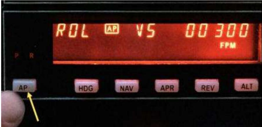
Nun schalten wir den Autopiloten ein (siehe. Gerät 6 auf Seite 7), indem wir die Taste ‚AP‘ drücken. Der Rollmodus (Anzeige ‚ROLL‘) zeigt an, dass das Flugzeug jetzt mit Hilfe des Autopiloten automatisch konstant horizontal ist.
